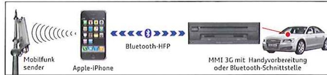
Über das Handsfree-Profil kann ein Mobiltelefon die Freisprechfunktion Ihres Fahrzeugs über das Innenmikrofon und die Audiolautsprecher nutzen. Das Gespräch wird über die Send-/Empfangseinheit des Mobiltelefons abgewickelt. Die Außenantenne des Fahrzeugs wird nur genutzt, wenn das Fahrzeug mit der Handyvorbereitung ausgestattet und das Mobiltelefon in ein optional erhältliches Adapterset eingelegt ist.
